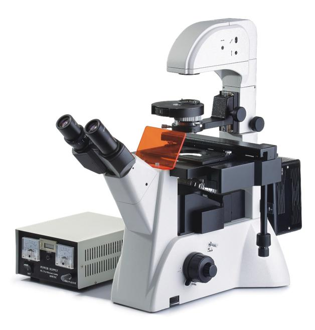
XDY-2倒置荧光显微镜由落射荧光显微系统与倒置生物显微系统组成,采用优良的无限远光学系统,配置长工作距离平场物镜与大视野目镜。紧凑稳定的高刚性主体,充分体现了显微操作的防振要求。旋转摆入摆出式聚光系统,可对高培养皿或圆筒状烧瓶进行无沾染培养细胞观察。落射荧光显微系统采用模块化设计理念,可以安全、快捷地调整照明系统,切换荧光滤色片组件。产品可应用于细胞组织,透明液态组织的显微观察,也可用于生物制药,医学检测、疾病预防等领域内的荧光显微术观察。
